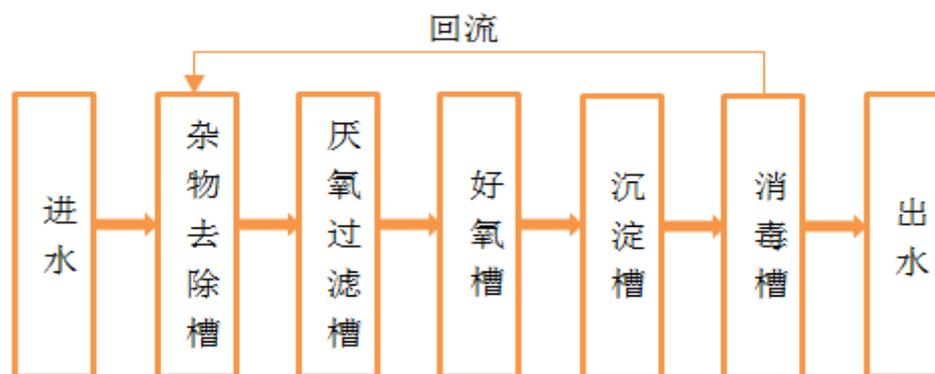
污水处理工艺流程图
